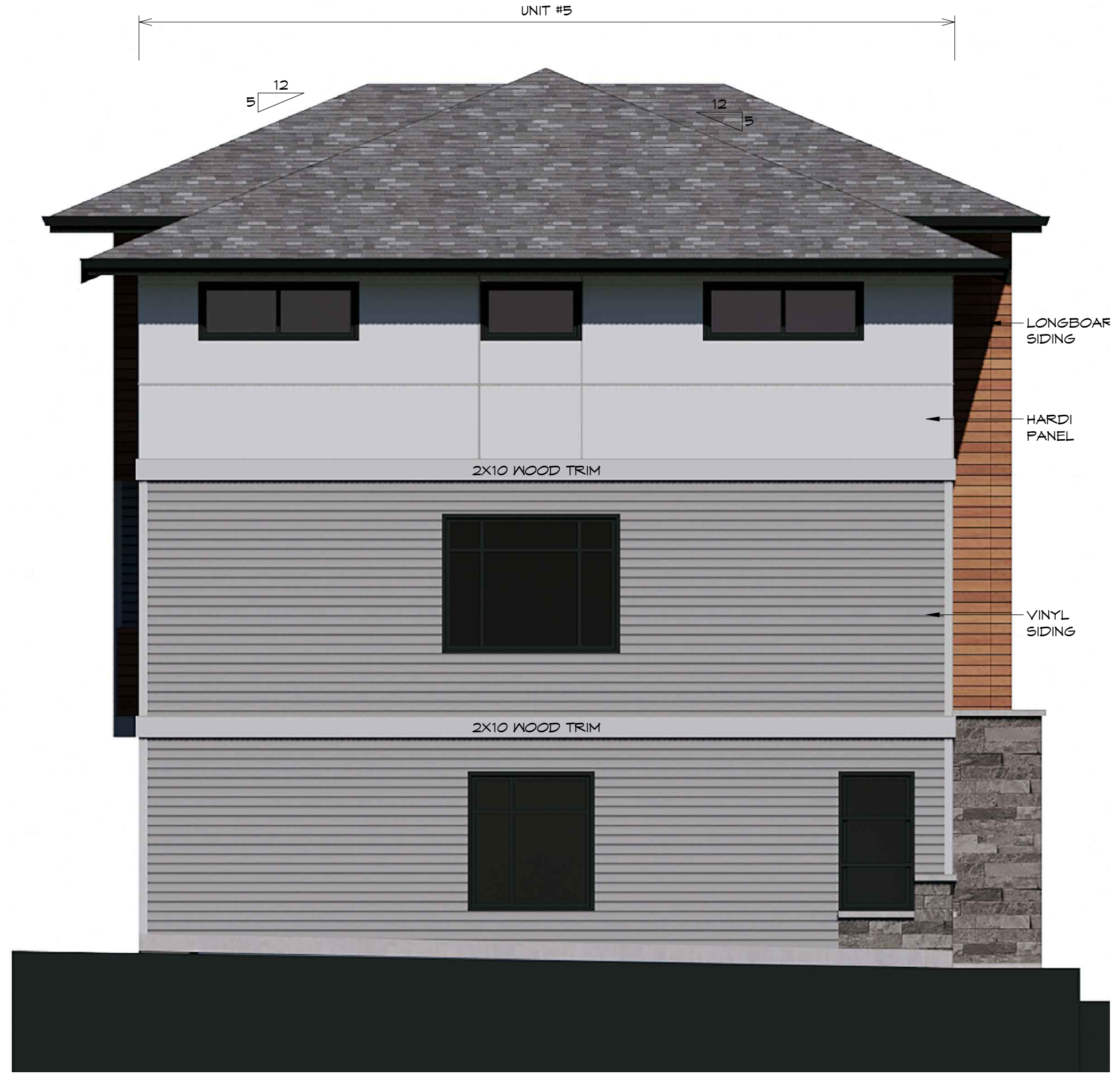
2 BUILDING #1 - LEFT (N.) ELEVATION A-3.1 SCALE: 1/4" = 1'-0"
